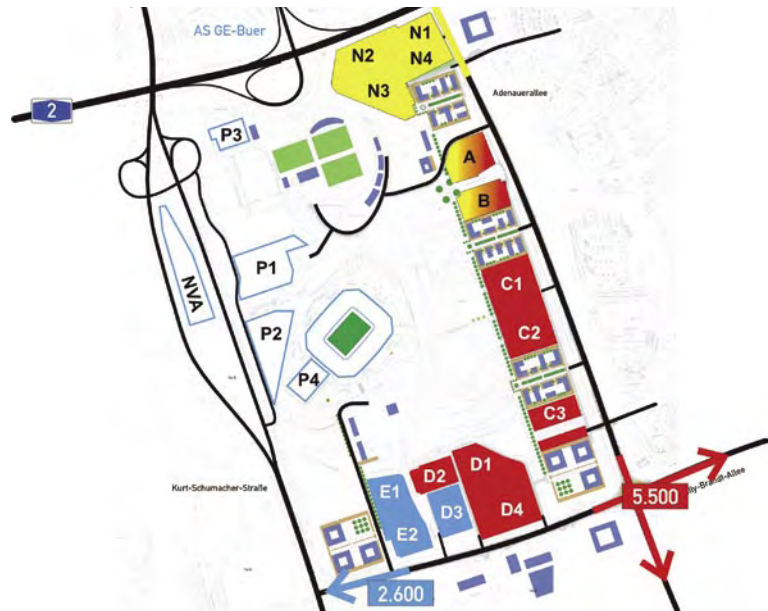
Abb.24 Zukünftiges Abflusskonzept bei Veranstaltungen in der Veltins-Arena
